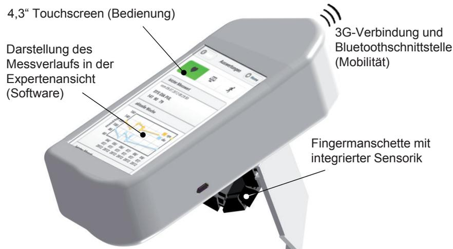
Bild 4-5: Funktionselemente des telemedizinischen Endgeräts
