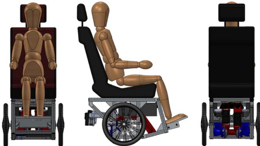
Abb. 1: AssistMobil-Sitz auf dem Rollstuhl-Fahrwerk in verschiedenen Ansichten (Schemazeichnung)
