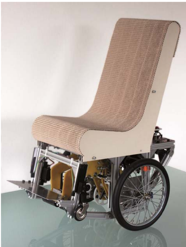
Abb. 2: AssistMobil-Rollstuhl als Technologie-Demonstrator im Maßstab 1:2
